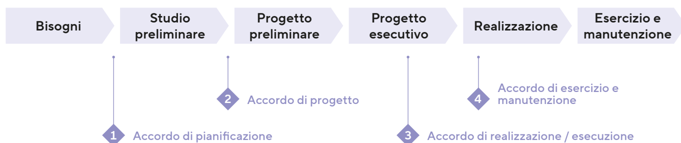
Figura 2: Possibili contratti durante lo svolgimento del progetto, elaborazione propria basata su informazioni delle FFS
